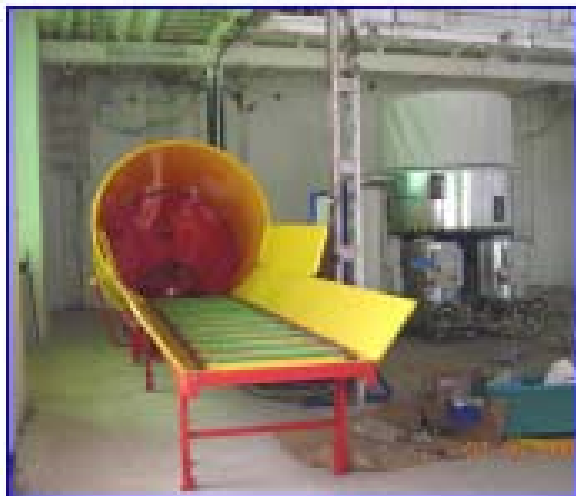
Figur 8. Tomasser, stationär eldriven balsnittare med matarbord för rund- och fyrkantbal i kombination med en briketteringspress. Källa: www.asket.pl .
