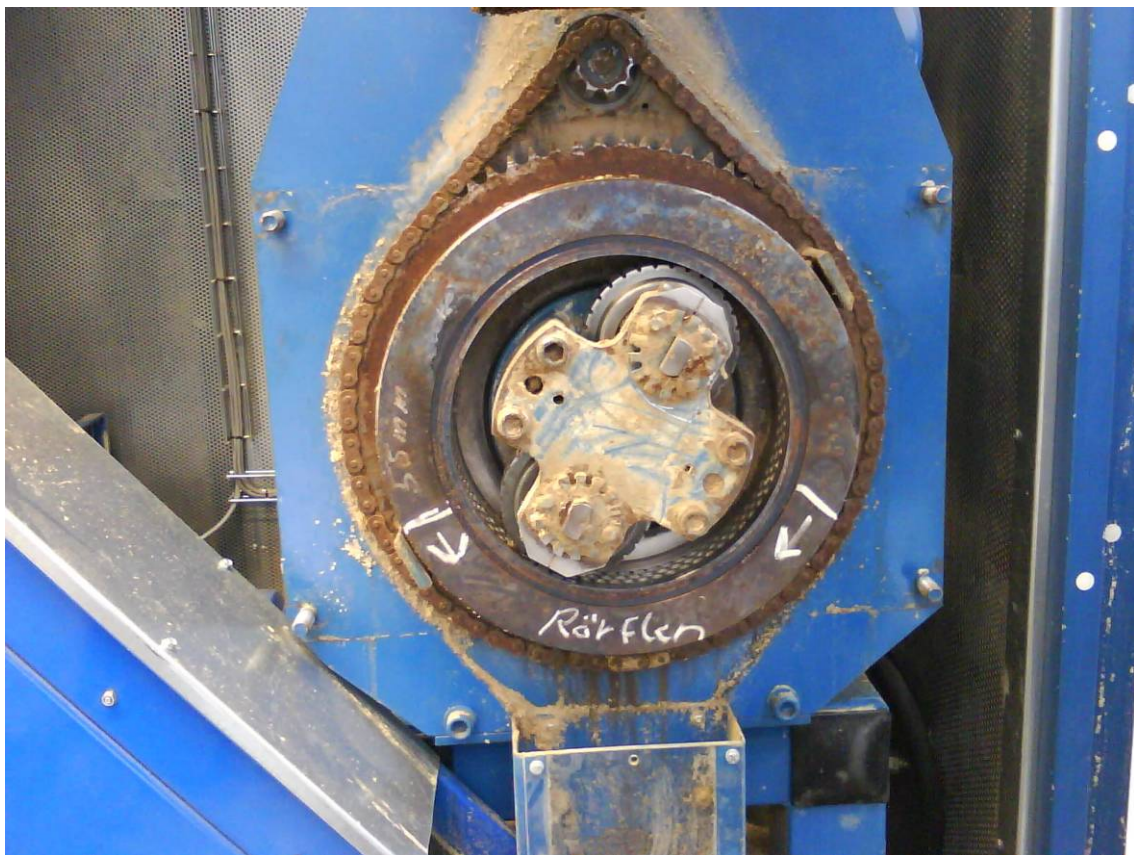
Figur 1. Principen för en SPC-pelletspress med två rörliga pressrullar och en fast matris.
