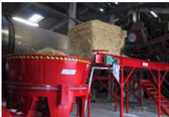
Figur 9. Cormall halmriv med tillhörande matarbord. Källa: www.cormall.dk
