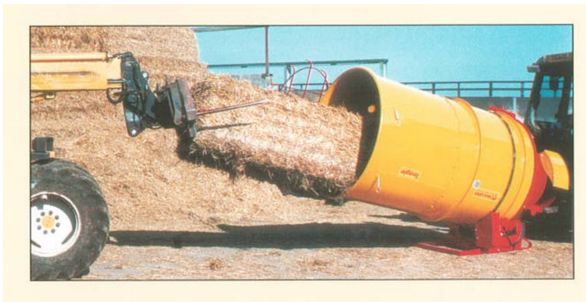
Figur 4. Traktordriven balsnittare Tomahawk 505M med förlängd trumma. Källa: www.trejon.se
