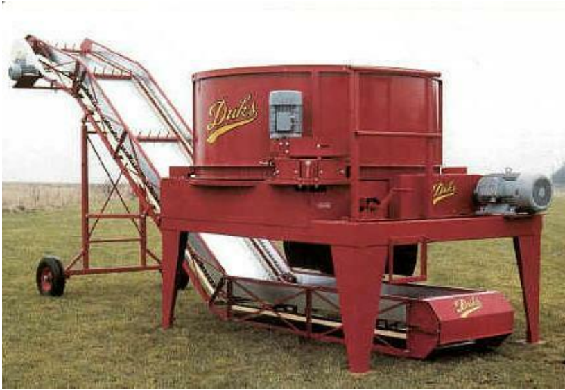
Figur 6. Duks, stationär eldriven balsnittare för rundbalar. Källa: www.Duksmaskiner.se
